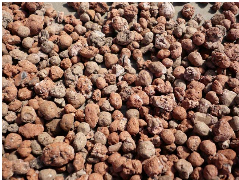
Obr.5: Vzorek expandovaného jílu
